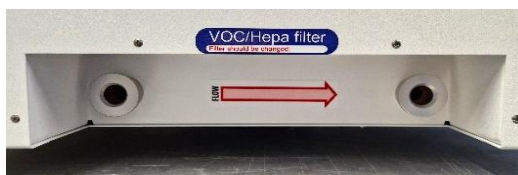
Figure 12.1 La flèche d'écoulement sur l'incubateur FIV multiroom MIRI® II-12
