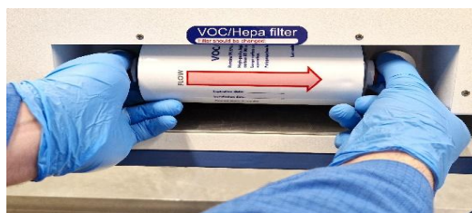
Figure 12.2 Procédure d'insertion et de retrait du filtre VOC/HEPA
